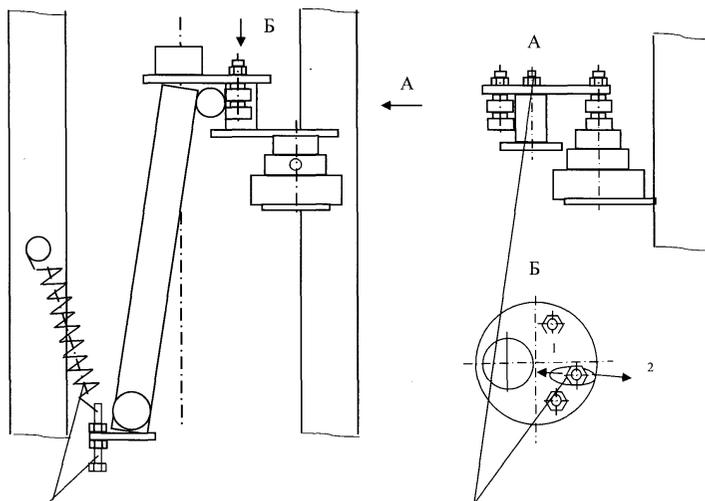
Натяжением пружины с помощью винта регулируется скорость на фазе быстрого возврата
