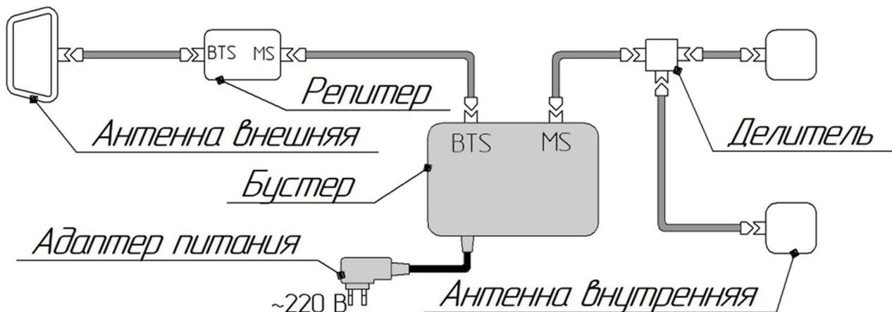
**ВНИМАНИЕ!** Отсоединять разъемы высокочастотных антенных кабелей (MS и BTS) при включенном питании бустера категорически запрещается! Это может привести к выходу бустера из строя. Обязательно отключайте питание (переключив выключатель Switch в положение «0») перед отсоединением антенных кабелей.
